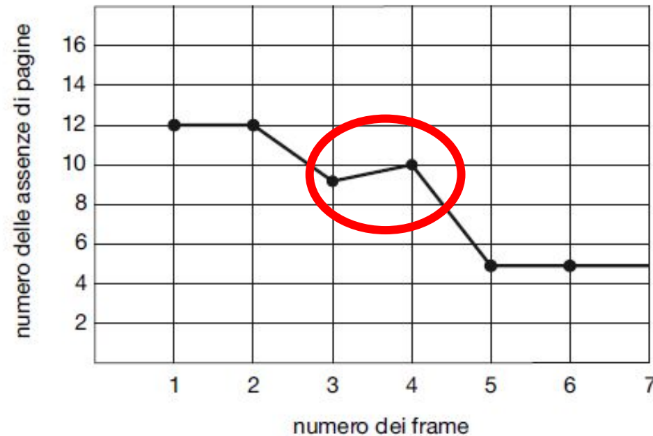
Figura 10.13 Curva dei page fault per la sostituzione FIFO su una successione di riferimenti.
